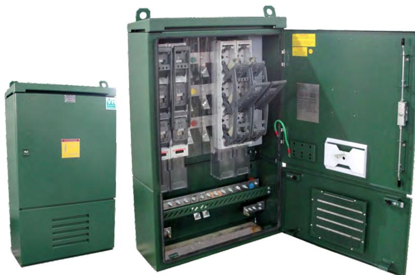
O Quadro de Distribuição Pedestal - QDP foi desenvolvido com a finalidade de acomodar dispositivos elétricos, sendo eles: seccionadoras verticais XLBM-0123-ABB suportes e barramentos destinados à manobra e proteção de circuitos secundários de energia em redes de distribuição subterrâneas.
